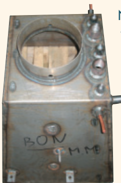
Foyer avec soudure étanche
